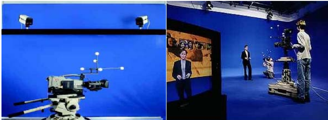
圖十：被動式紅外線追蹤系統（圖片來源：THOMA 公司網頁）
